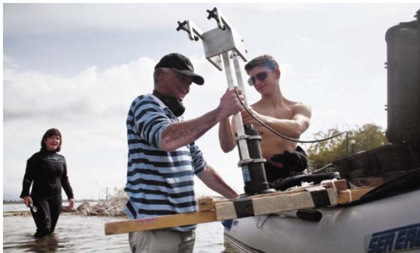
Установка на лодку прибора придонного профилирования для дистанционного зондирования.
